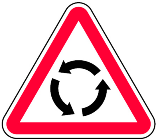
A24a - INTERSEÇÃO COM SENTIDO GIRATÓRIO: indicação da proximidade de uma interseção com sentido giratório. O trânsito se processa pela forma indicada pelas setas
